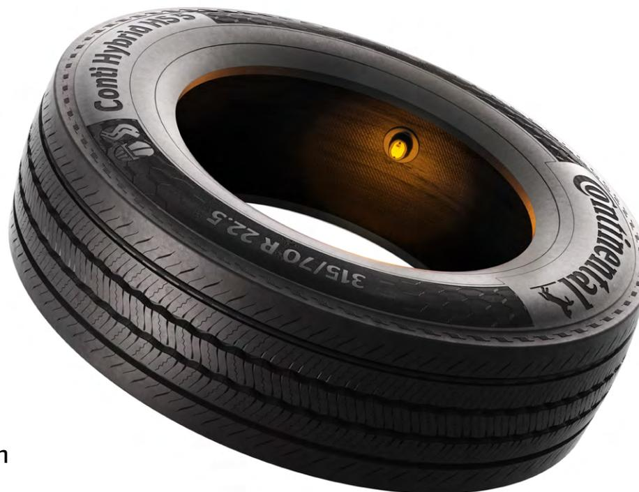
direkten Kontakt zur Luft im Reifen. Sie bestimmen die physikalischen Größen in Echtzeit und übertragen sie an das Steuergerät im Fahrzeug oder in die Cloud von Continental. Die Auflösung der Druckmessung beträgt 0,1 bar oder sogar weniger. Die Reifensensoren erkennen also geringe Schwankungen bereits sehr frühzeitig, zeigen ein Abweichen an und erzeugen einen Alarm. Die Sensoren der dritten Generation von Continental stellen zudem Daten zur Profiltiefe des Reifens zur Verfügung.
