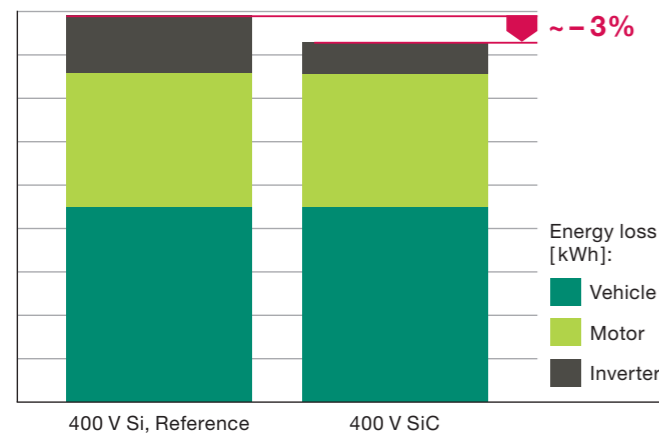
Bild 1: Effizienteres Schalten im SiC-Inverter im Vergleich zur heutigen Si-Technologie jeweils bei 400 V mit gleicher Flankensteilheit (5 kV/ \mu s) und gleicher Taktfrequenz (10 kHz)
