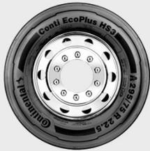
Der **Conti EcoPlus** (3. Generation) spart im Vergleich zur Vorgängergeneration (L-Linie, Generation 2) bis zu **1,9 l/100 km Kraftstoff**, bezogen auf alle Achsen ein.
