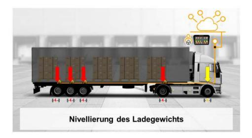
Ebenfalls intelligent ist unser **elektronisches Luftfedersystem**. Wir haben es erweitert. Um eine Art eingebaute Waage. Sie zeigt durchgehend das Ladegewicht an. So macht sie auf Überlast aufmerksam. Das hilft den Fahrern. Das hilft den Eignern. Denn der Transport entspricht dann den gesetzlichen Vorschriften. Damit ist der Verkehr sicherer. Und ein Lkw ohne Übergewicht schont die Straßen.
