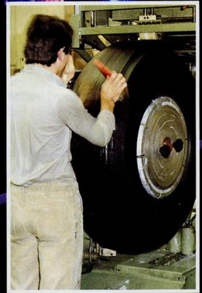
Vergölst. Neue Fertigungstechnik in der Runderneuerung, eine Kombina- tion aus Extruderstraße, Material- speicher, Zubringer und Beleg- maschine.
