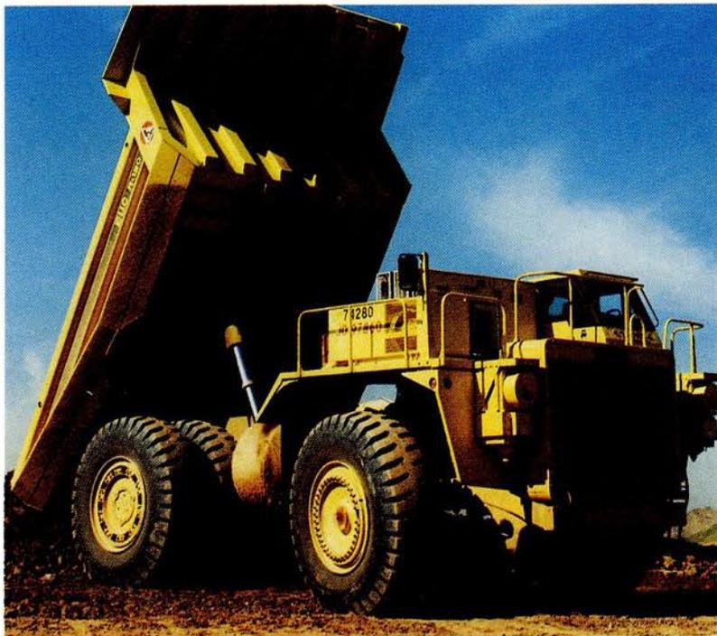
*Durch einen bei General Tire entwickelten Reifen-cord sind die Reifen höchsten Anforderungen, wie zum Beispiel im Bergbau, gewachsen.*
