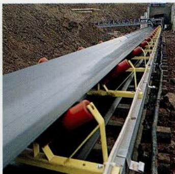
*Textil-Gewebegurte im Einsatz auf einer 7 km langen Förderstrecke in einem ostdeutschen Ziegeleiwerk.*
