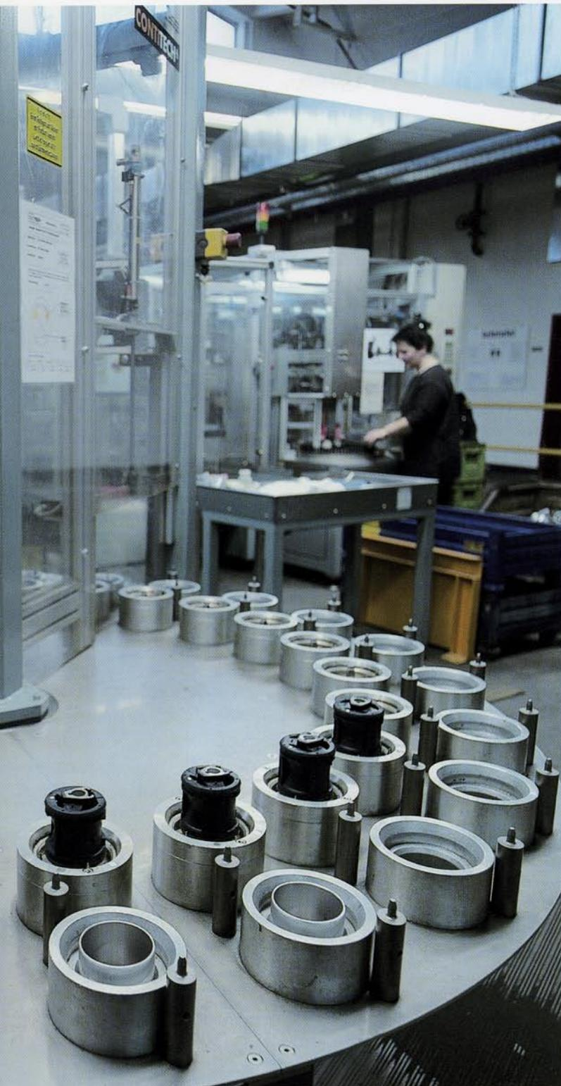
Vollautomatische Befüllstation für Pkw-Hydrobuchsen
