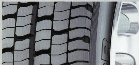
Kilometer „im ersten Leben“. Für Lkw-Flottenbetreiber ist Runderneuerung von großer Bedeutung. Conti-Reifen für den Schwerverkehr werden so konstruiert, dass die Nutzungsdauer nicht nur durch Nachschneiden, sondern auch durch Runderneuerung erheblich verlängert werden kann. Mehr als die Hälfte aller Lkw-Reifen werden ein bis zwei Mal runderneuert. Daraus ergibt sich eine Gesamt-Lebensdauer von rund einer Million Kilometer für eine Continental-Karkasse.
