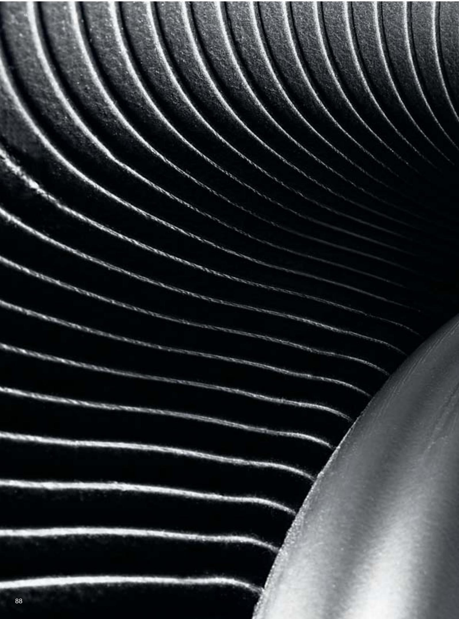
Die spezielle Gummiverstärkung in der Seitenwand des Self-Supporting Runflat Tire nimmt nach Druckverlust das Fahrzeuggewicht auf und ermöglicht so, noch 80 Kilometer bei maximal 80 km/h weiterzufahren.
